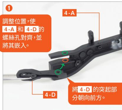
將前下臂 4-D 插入前懸吊結構 4-A 如照片的位置，並調整螺絲孔對齊。
