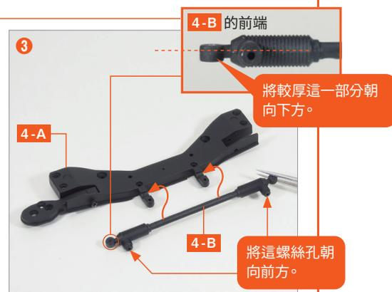
將齒輪齒條式轉向器 4-B 的軸部分裝在 4-A 的組裝位置。
