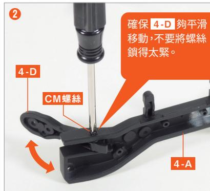
在步驟 1 已對齊的螺絲孔上放入 CM 螺絲 穿到 4-A 的相對側並進行螺絲固定。確認 4-D 能夠移動。
