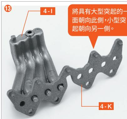
將墊片 4-K 具有突起的一面朝向此側，將進氣歧管 (L) 4-I 的3個足端突起與 4-K 的洞孔從背面對準後插入。
