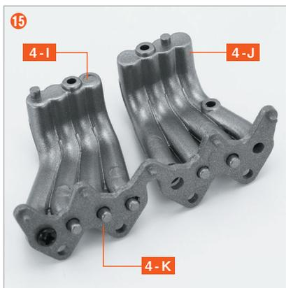
將進氣歧管 (R) 4-J 的2個足端突起，如照片所示插入 4-K 的洞孔中。
